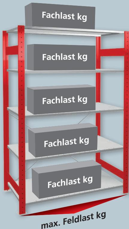
Die **Fachlast** beschreibt die maximale Belastung eines einzelnen Fachbodens bei gleichmäßig verteilter Last.
